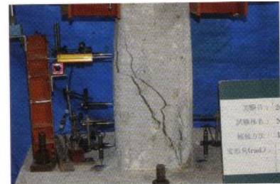
6 せん断破壊試験状況 負側 1/50 第1回目 せん断破壊位置は、注入位置ではなくオリジナルコンクリート。
